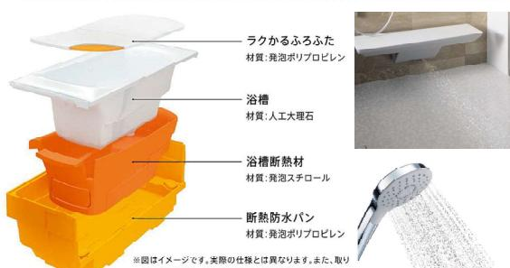
※図はイメージです。実際の仕様とは異なります。また、取り付ける器具によって浴槽断熱材の形状が異なり、浴槽の部が浴槽断熱材に覆われていない仕様となる場合があります。
